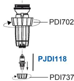
3. Desatornille la tuerca de seguridad (PDI746), remueva la arandela en forma de "C" (PDI751). Desatornille la manga de ajuste (PPDI037). Sujetando la manga negra, jale hacia abajo el cono (barra blanca), empuje hacia arriba la parte del cono de inyección con rosquilla (PDI743) y sáquela completamente de la manga. Reemplace ambos o-rings, el de la manga y el del cono de inyección (JDI100 y JDI122).
