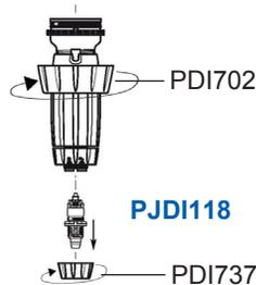
7. Inserte todo el montaje de inyección en la unidad, empujándolo completamente hasta que esté en posición. Girando el montaje de inyección, usted puede asegurarse que la escala deseada (Porcentajes o proporciones) se encuentra en la parte frontal del inyector. Atornille la tuerca (PDI702). Inserte la manguera en la parte inferior al final de la válvula cheque (PJDI118) y atornille la tuerca de la manguera (PDI748) en su lugar.
